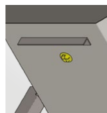
Tappi di scarico Ø 35 mm ad entrambe le estremità.
