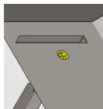
Abflusstopfen Ø 35 mm an beiden Enden.
