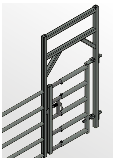
Die Tür ist in einem verstärkten Rahmen aus 60x60 mm-Rohr enthalten.
